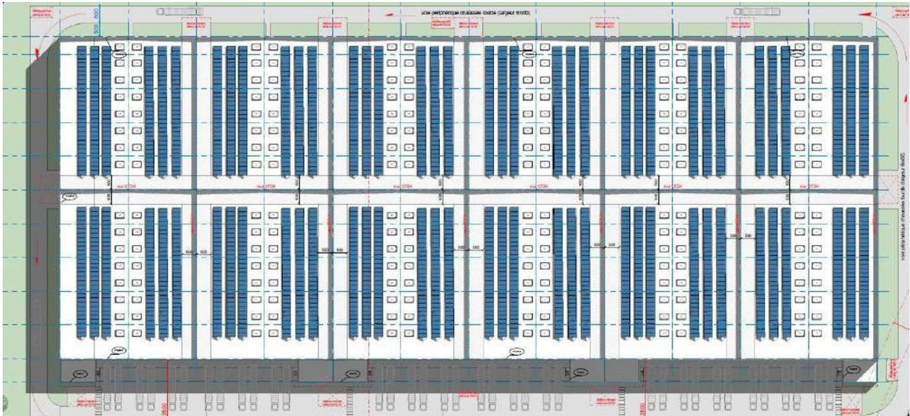
**Figure 3 : Organisation des panneaux photovoltaïques en toiture de l'entrepôt logistique (extrait PC)**
